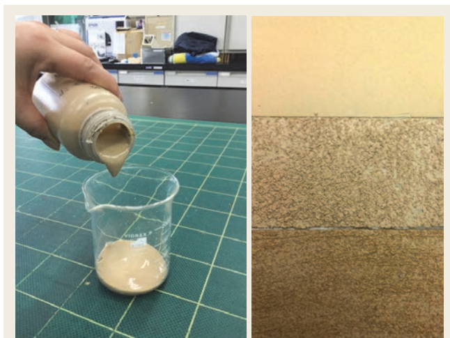
写真1 開発した木粉塗料(左)と塗装外観*(右) *木粉粒度を変えて塗装
